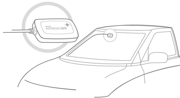
**Note :** La zone non athermique du pare-brise dépend du modèle de votre véhicule. Elle se trouve généralement au niveau du rétroviseur.
