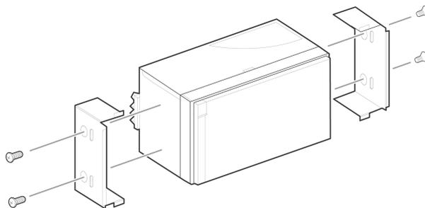
3. Positionnez le Parrot ASTEROID Smart de manière à ce que les trous de vis soient alignés avec les trous de vis du véhicule.
